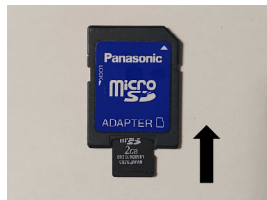
画像：microSD カードのアダプタ に microSD カードのアダプタを差 し込む
