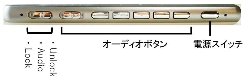
画像：シックスミニ前面の電源ボタンとオーディオボタンとキーロックスイッチ
