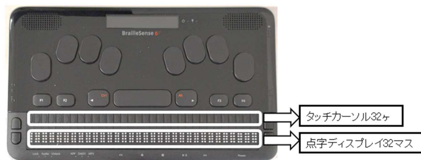
画像：シックスの点字ディスプレイとタッチカーソル
